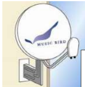
(B)1 階壁面・軒先取付 (外壁の壁面)
