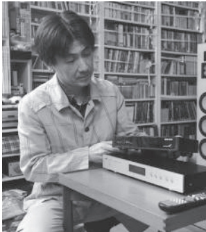
MDT-5CSのサイズは430W×60H×165Dmm(重さ2.4kg)。幅はハイエンドモデルConclusion CT1-CSと同じで、コンポシステムとしての存在感を保ちつつ、高さ・奥行はコンパクトにまとめられている
