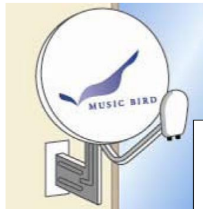
(B) 1 階壁面・軒先取付 (外壁の壁面)
