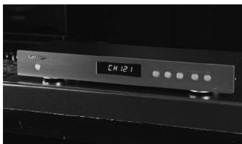
●ミュージックバード専用チューナー Conclusion C-T3000CS オープン価格（参考販売価格¥129,800） 2019年12月19日発売（ダイレクト販売専用：50台限定生産） 電源回路における理想的な直流電源の供給を実現するため、NECによるかつての名機プリ・メインアンプ「A-10」シリーズで使われ話題となったリザーブ電源を見直し新たに設計・搭載した高音質志向モデル。さらに、チューナー電源用とオーディオ回路電源用にそれぞれ巻き線をもつRコアトランスも新たに設計し、搭載されている。 ※購入の相談はミュージックバード カスタマーセンター（☎03-3221-9000）まで
