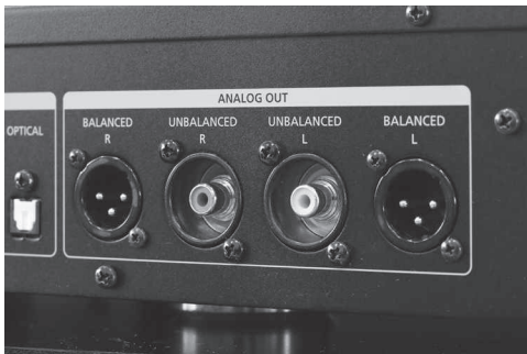
アナログ音声出力はRCAに加え、XLRバランス出力にも対応。同軸出力部もあわせ、端子には信頼性の高いノイトリック製のものを採用する
