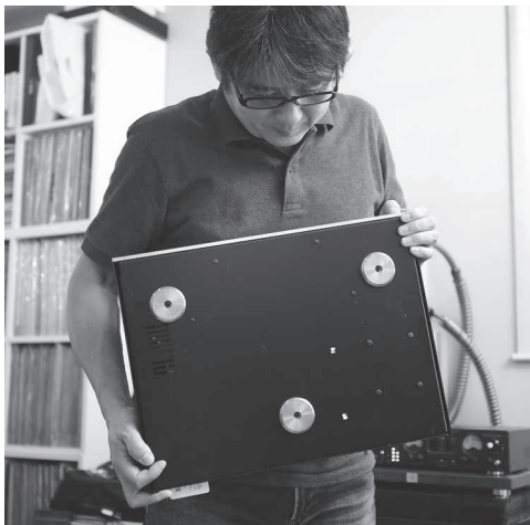
真鍮削り出しの脚部。三点支持式を採用する
